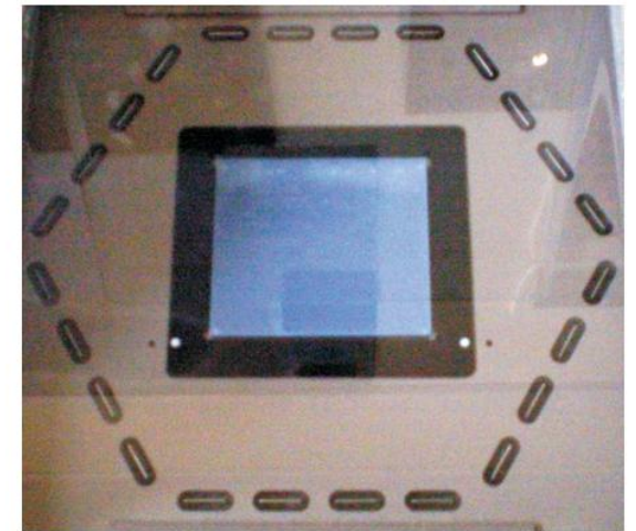
1.40. ábra. PFGE készülék futtatókádja (középen a géllal) a körben elhelyezkedő elektrodokkal, amelyek lehetővé teszik a váltakozó irányú áram létrejöttét
